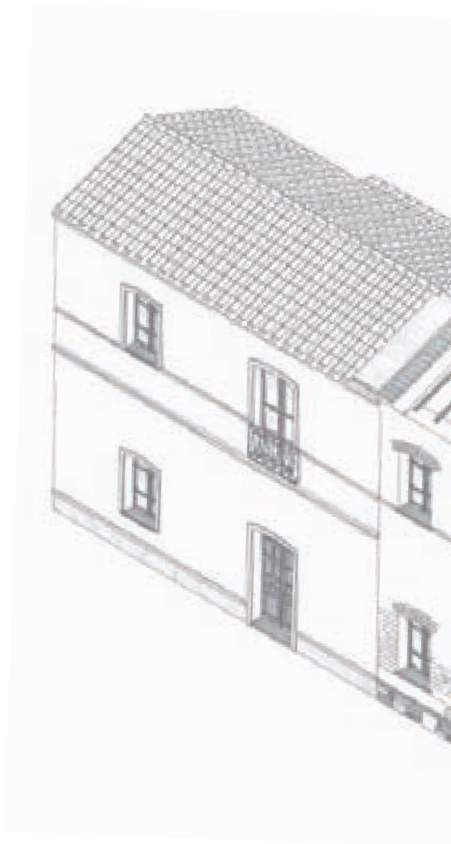
Dettaglio della portafinestra con balcone su strada e dell'apparato decorativo costituito da cornici marcapiano in mattoni laterizi.
