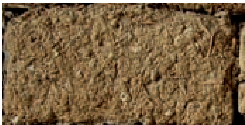
Fig. 3.33. Serrenti. L'impasto di terra aumenta le sue capacità meccaniche e di resistenza termica con l'aggiunta di una certa quantità di paglia.
